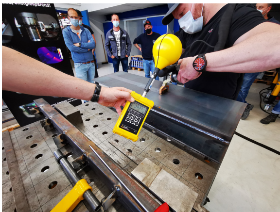
Abbildung 1: Messung der magnetischen Feldstärke beim induktiven Richten
