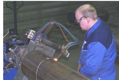
3-achsiges Schneidgerät für den Zuschnitt an Enden gebogener Rohre
