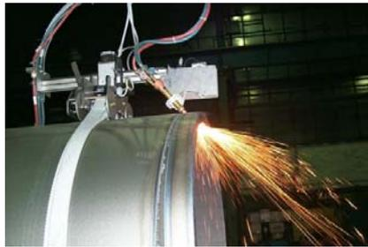
3-achsiges Umlauf-Schneidgerät zur Bearbeitung von Rohren großen Durchmessers
