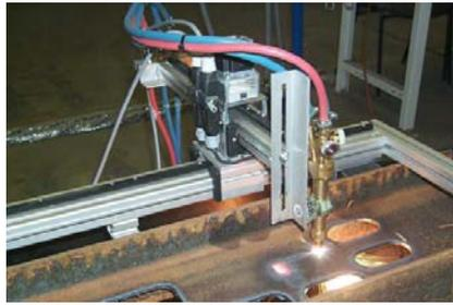
2-achsiges Schneidgerät zur ebenen Bearbeitung an räumlichen Bauteilen
