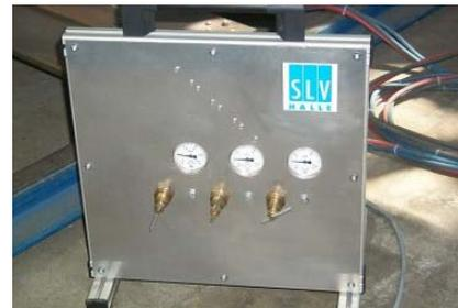
autogene Brennschneid-ausrüstung mit Gasverteilerbaugruppe bis 100 mm Wanddicke
