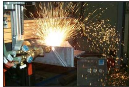
4-achsiges Schneidgerät zum Schlitz von Rohren ohne und mit Nahtvorbereitung und Klinken von Profilträgern
