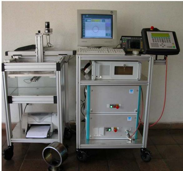
Bild 3: Prüfanlage für Flanschverbindungen
