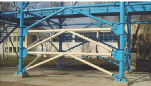
In Kombination mit Dehnungsmessungen am Knotenprofil und unter Einbeziehung der am Tragwerk aufgenommenen Daten wie Windgeschwindigkeit und Richtung sowie Temperatur erhalten die registrierten Schallemissionsdaten einen Bezug zur Beanspruchung des Segmentes. Eine zeitlich begrenzte Überwachung kann mit der zur Verfügung stehenden Gerätetechnik durchgeführt werden. Geschieht diese unter zusätzlicher Lastaufbringung, so gestaltet sich die Überwachung in Form von Prüfeinsätzen,
