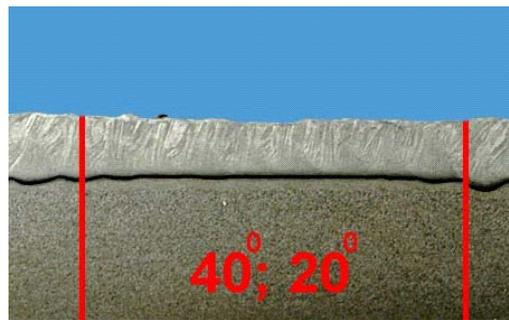
Bild 1: Einbrandtiefe und Aufmischung bei einem Brenneranstellwinkel von  $40^{\circ}$  und  $20^{\circ}$  stechender Brenneranstellung
