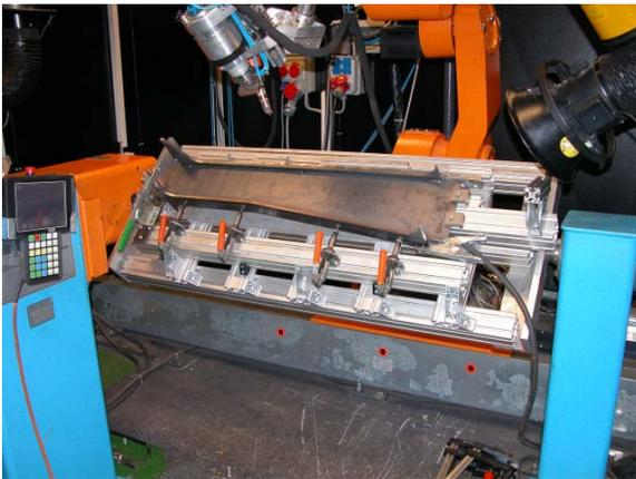
Bild 1: Bauteilvorrichtung der Roboterzelle
