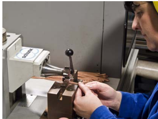
Pressschweißprozesse zum Kompaktieren und Verschweißen von Baugruppen für den Schaltanlagenbau
