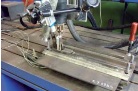
Schweißversuche mit induktiver Vorwärmung und Temperaturmessung am S960QL
