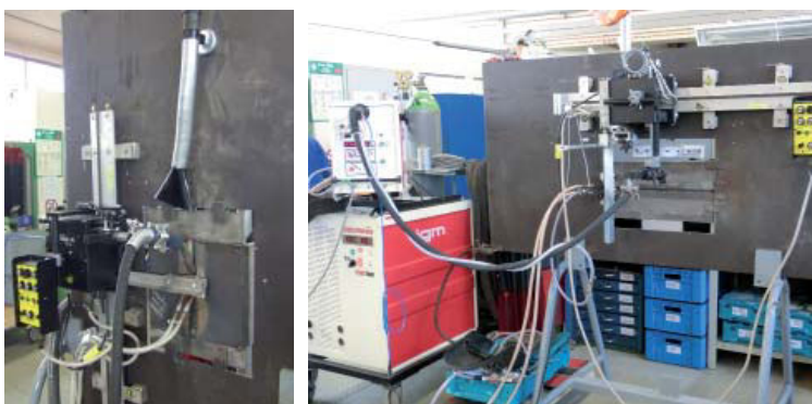
Positionsschweißversuche steigend (PF) links und Quernaht (PC) rechts
