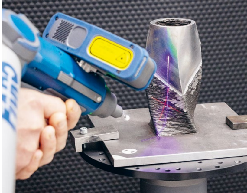
FARO QuantumMax ScanArm mit blauem Laserlinienscanner und taktiler Taster.
