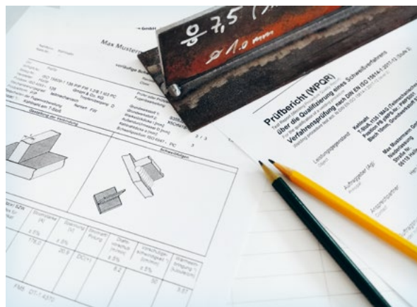
Abschließende Schweißanweisung nach positivem Ergebnis.
