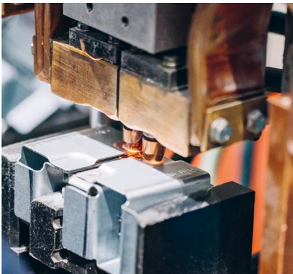
Pressschweißen: Schweißprozesse für die Massenfertigung.
