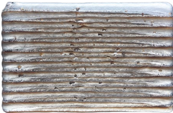
Beispiel für Bahnplanungsdaten, hier Volumenaufbau eines Quaders.
