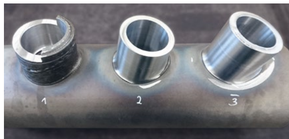
WAAM-generierte Rohrstützen in unterschiedlichen mechanischen Bearbeitungsphasen.
