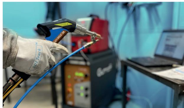
Neue Anlage zum handgeführten Laserstrahlschweißen © ifw Jena
