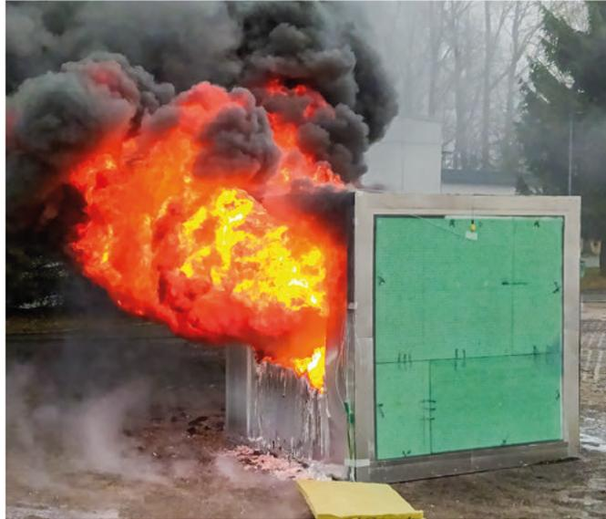
Im Forschungsprojekt durchgeführter Brandversuch an der MPA Dresden eines hybriden Containers (Bild: SLV Halle GmbH)
