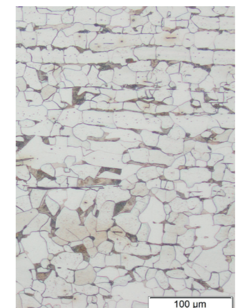
Mikrogefüge des historischen Werkstoffes mit Mangansulfid-Ausscheidungen © SLV Halle GmbH 2024
